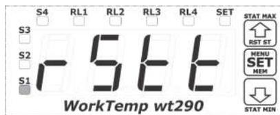
**ATENÇÃO:** Os valores das temperaturas máxima e mínima são mantidos através de uma bateria interna do tipo moeda modelo cr2032/cr2025. A bateria garante que os valores não se percam quando o aparelho for desligado. Caso esses valores vim a se perderem é o momento de trocar a bateria.
